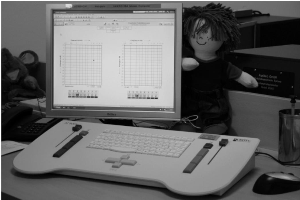
Abbildung 2.4: Audiometriemodul AT900
